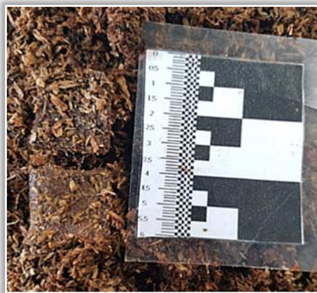
Abbildung 3: Zersetzungszustand von mit Triose gegerbtem Wet-White nach Tag 11 (ISO 20200).
